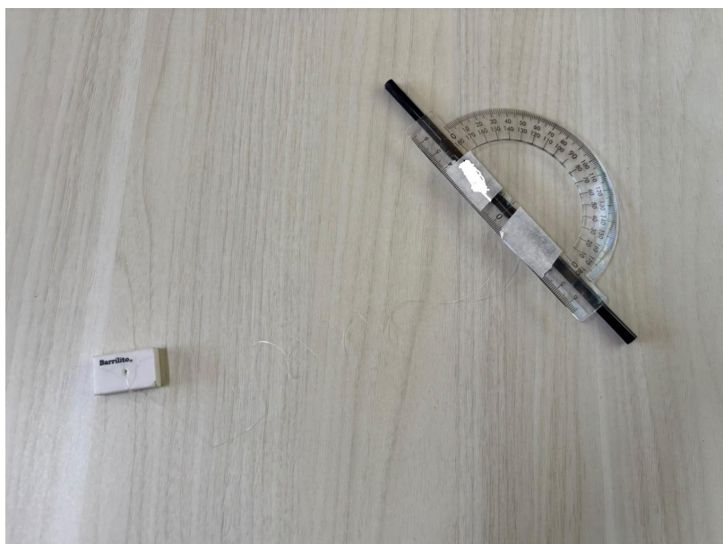
Figura 12 – Teodolito caseiro pronto para utilização
